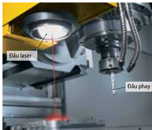
Hình 1: Gia công bằng tia laser trên một máy phay
