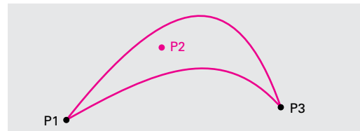
Hình 4: Đi vòng qua do chuyển động PTP
