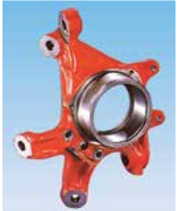
Hình 1: Giá mang bánh xe của ô tô bằng gang cầu
