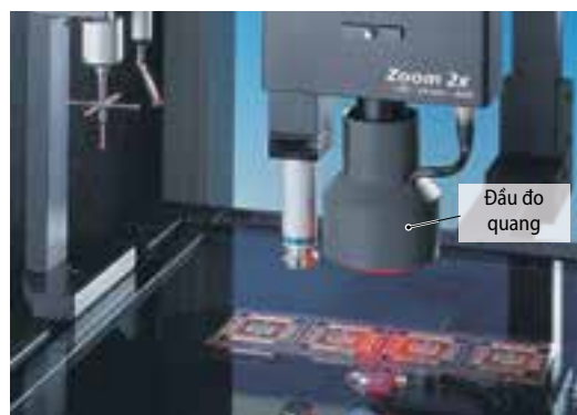
Hình 2: Sự số hóa hình ảnh của tấm đỡ linh kiện (bo mạch) với đầu đo quang
