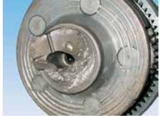
Hình 1: Trục hộp số bị gãy
