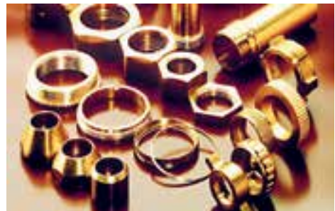
Hình 4: Chi tiết tiện bằng hợp kim đồng-kẽm
