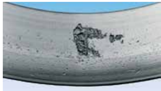
Hình 3: Tổn hại môi ở bề mặt vòng lăn ngoài của vỏ bạc đạn côn
