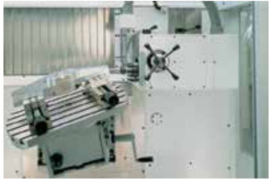
Hình 1: Bàn gia công vạn năng và đầu phay ở thể trục chính nằm ngang (nghiêng 90°)
