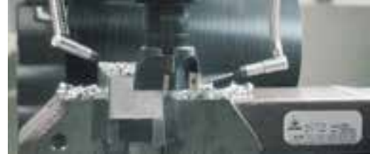
Hình 2: Lượng bôi trơn tối thiểu ở phay với một đầu phay
