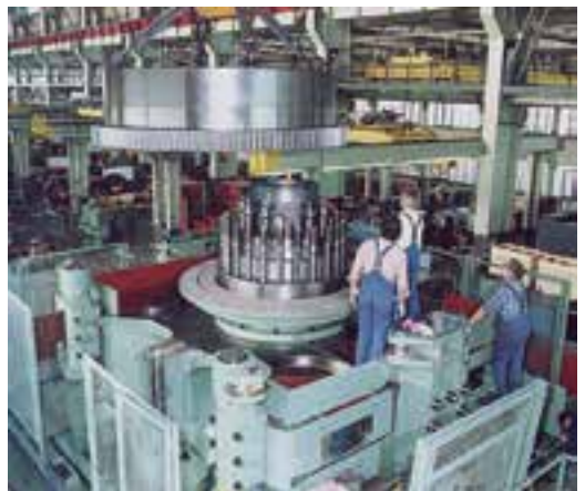
Hình 5: Lắp ráp cố định của máy ép chày
