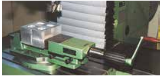
Hình 1: Ê tô máy (Mở cặp máy)
