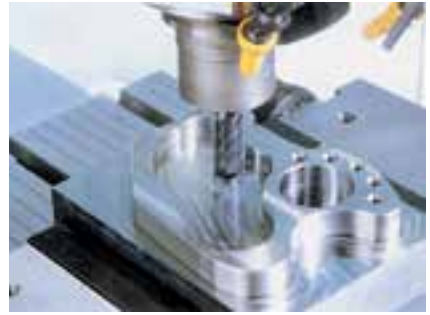
Hình 1: Cắt đứt (Phay)
