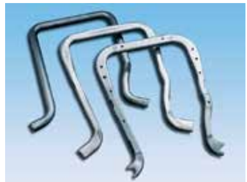
Hình 3: Khung treo bánh xe trước của ô tô (Nhiều công đoạn sản xuất)
