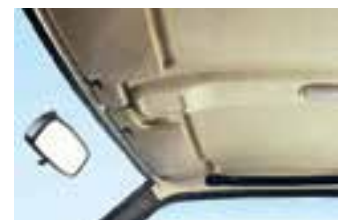
Hình 5: Vỏ che trần ô tô được dán từ chất xốp đàn hồi hợp polyuretan
