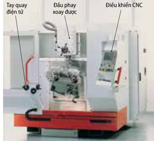
Hình 1: Máy phay vạn năng với bàn gia công vạn năng
