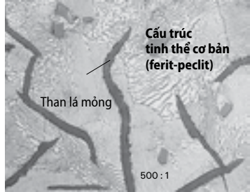
Hình 1: Cấu trúc của gang với than lá mỏng
