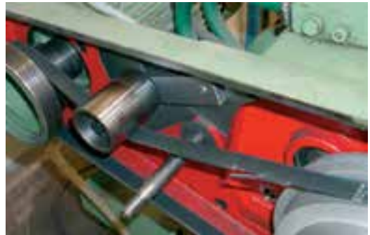
Hình 2: Động cơ truyền động với dây đai bị đứt
