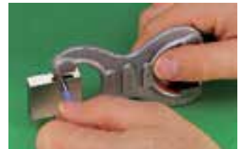
Hình 4: Kiểm tra calip hàm giới hạn với căn mẫu và chốt kiểm tra.
