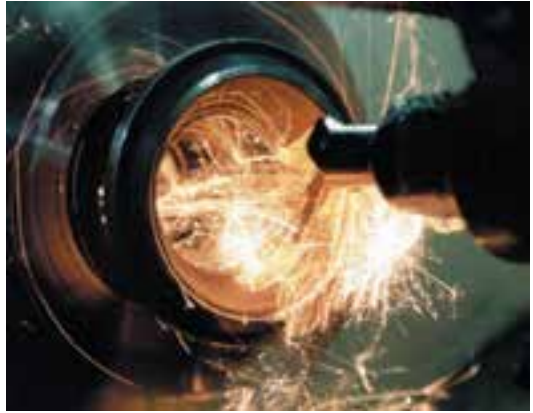
Hình 1: Tiện cứng một lỗ khoan
