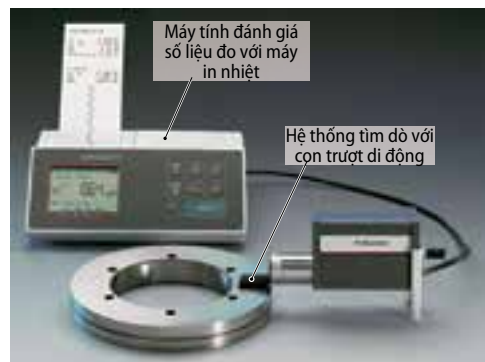
Hình 3: Thiết bị đo xách tay với hệ thống tìm dò bằng con trượt di động
