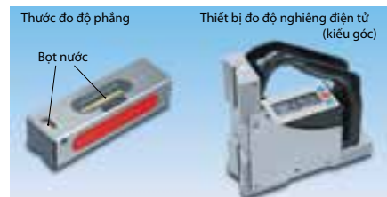
Hình 5: Thước đo độ phẳng và thiết bị đo độ nghiêng
