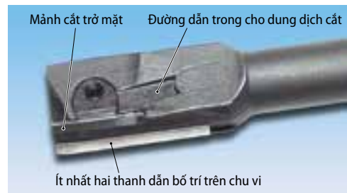
Hình 5: Lưỡi doa với thanh dẫn hướng
