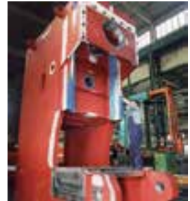
Hình 1: Sườn máy nén được hàn bằng thép tinh thể mịn
