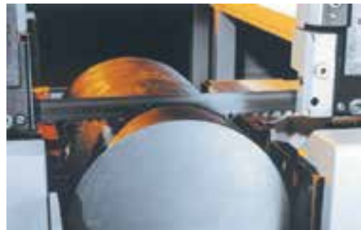
Hình 2: Máy cưa dây vòng
