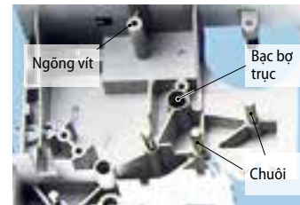
Hình 4: Khung thiết bị với trục đúc dính vào và ổ trục
