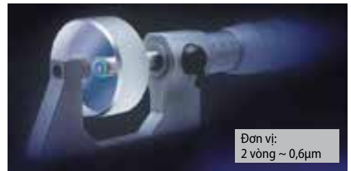
Hình 4: Kiểm tra độ song song và độ phẳng của mặt đo bằng kính kiểm tra với mặt phẳng song song
