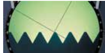
Hình 3: Đo ren bằng phương pháp quang học
