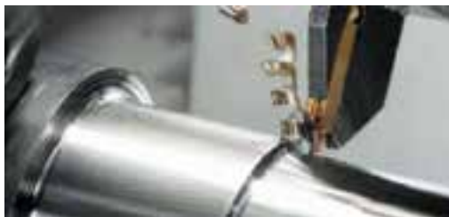
Hình 4: Dụng cụ tiện chích để chích rãnh và tiện dọc
