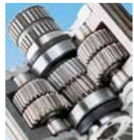
Hình 3: Bánh răng làm bằng thép thấm carbon (thấm than)
