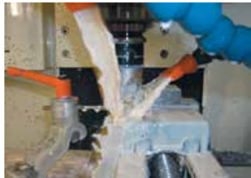
Hình 2: Làm nguội bôi trơn với dầu nhũ emulsi
