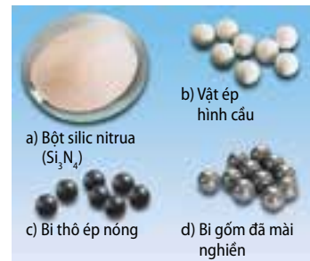
Hình 5: Những giai đoạn sản xuất bi gốm cho vòng bi (ổ lăn)
