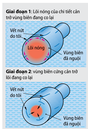
Hình 4: Sự hình thành của biến dạng và nứt do tôi
