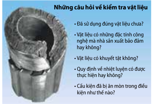
Hình 1: Trục rỗng bị gãy và những nguyên nhân gây có thể vì lý do vật liệu
