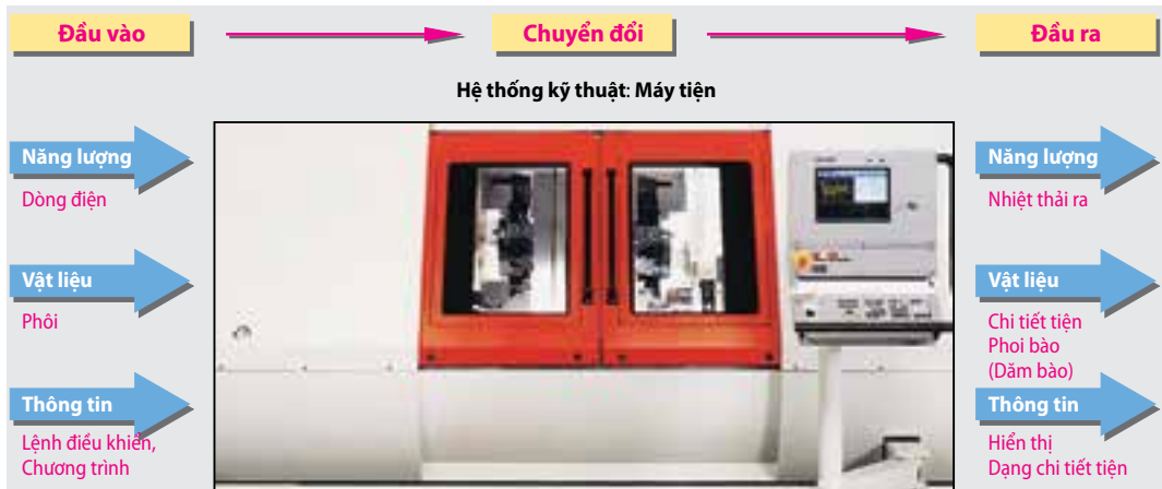
Hình 1: Máy được xem như là hệ thống kỹ thuật qua thí dụ ở một máy tiện
