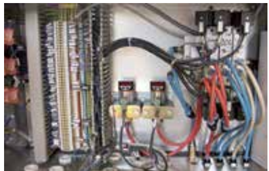
Hình 3: Cụm thiết bị điện-khí nén
