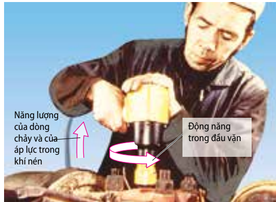
Hình 3: Chuyển đổi năng lượng trong thiết bị vận vít bằng khí nén
