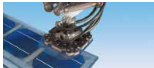
Hình 3: Tay cầm giữ bằng chân không trong việc xử lý chip
