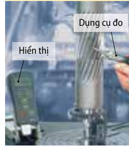
Hình 1: Kiểm tra độ cứng di động
