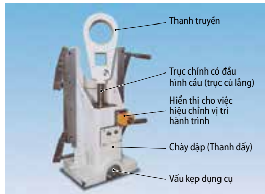
Hình 3: Cụm lắp ráp chày đập của máy dập lệch tâm
