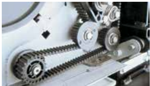
Hình 3: Đai răng dẹt đôi trong máy sao chép
