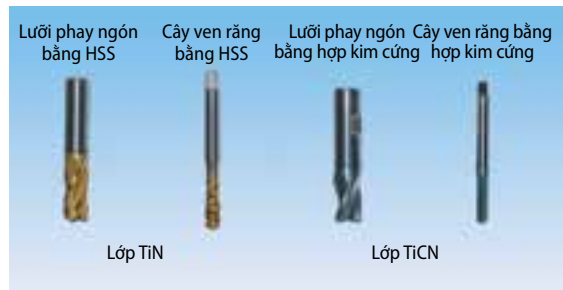
Hình 2: Dụng cụ cắt với các lớp phủ khác nhau
