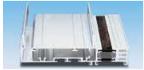
Hình 1: Profin làm vật liệu xây dựng (bằng hợp kim dẻo AlMg3 không tôi được) sản xuất từ phương pháp đúc ép đùn liên tục
