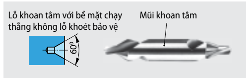
Hình 1: Lỗ khoan tâm với mũi khoan tâm
