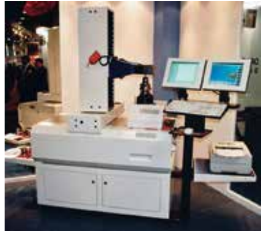
Hình 1: Chỉnh trước dụng cụ với sự trợ giúp của máy tính
