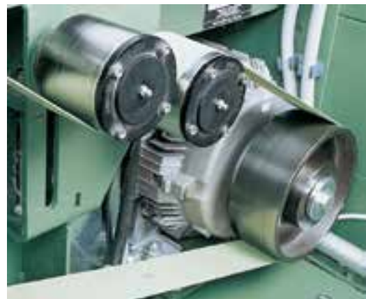
Hình 2: Truyền động với dây đai bản (dẹt)
